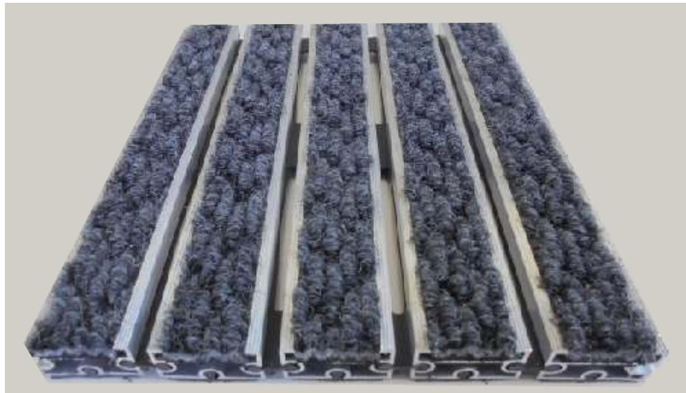
Zerbino tecnico composto da profili portanti in alluminio estruso antitorsione correati da apposita guarnizione fonoassorbente nel lato inferiore. Cerniere drenanti oppure piene per permettere l'aspirazione dello sporco senza sollevare lo zerbino.
